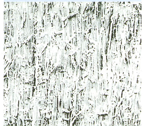
Rasterelektronenmikroskop-Aufnahme: Werkstückoberfläche geschliffen
